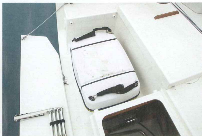
Simpler mit Rüssel. Der ausziehbare Bugsprit bringt mehr Leistung und erleichtert das Halsen. Die Stauboxen im Cockpit sind demontierbar. Die Badeplattform schließt den Stauraum für die Rettungsinsel ab. Eine größere Klappe gibt es als Option
