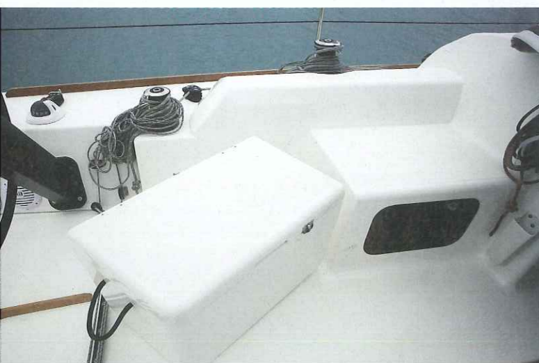
Simpler mit Rüssel. Der ausziehbare Bugsprit bringt mehr Leistung und erleichtert das Halsen. Die Stauboxen im Cockpit sind demontierbar. Die Badeplattform schließt den Stauraum für die Rettungsinsel ab. Eine größere Klappe gibt es als Option
