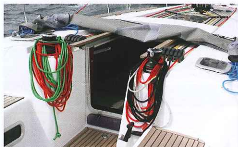
Classica e funzionale la postazione del drizzista, con il tambuccio a rientrare che dà la possibilità di appoggiarsi a barca sbandata
