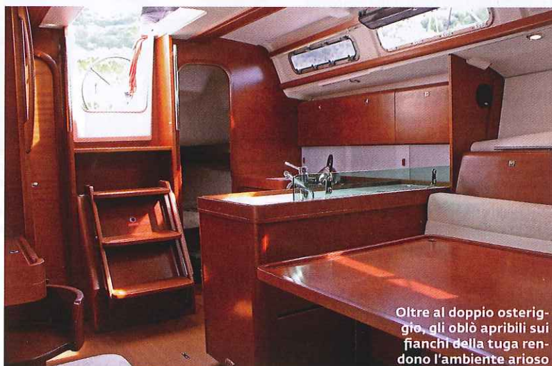
Orientato per baglio, il carteggio ha una seduta pivotante, soluzione poco pratica a barca sbandata
