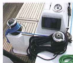
La bussola e gli strumenti montati all'estremità dei paraonde sono visibili solo dal randista o dal timoniere
