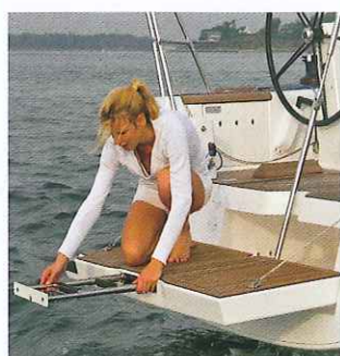
Per il bagno, una scaletta è integrata alla piattaforma mobile che chiude lo specchio di poppa. Notate il vano per l'autogonfiabile sotto il pavimento
