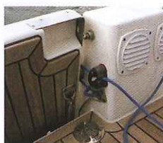
Una cima, un semplice strozzatore e un fermo a pulsante metallico per la movimentazione della plancetta di poppa
