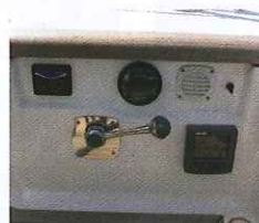
I comandi motore e lo schermo del pilota automatico a destra, incastrati e ben riparati, ma un po' bassi
