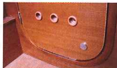
Tra i dettagli indovinati, queste aperture nella parte bassa delle porte consentono la circolazione d'aria a barca chiusa
