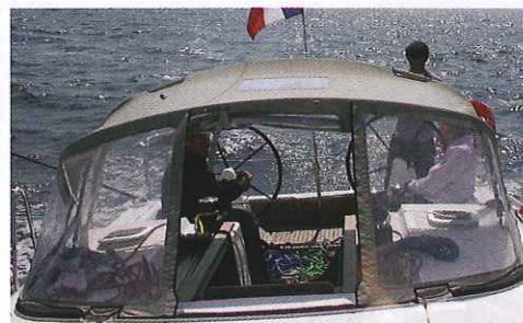
Indispensabile lo sprayhood, altrettanto necessaria la sua apertura frontale. Peccato che manchi un alloggio nella tuga per il suo rimessaggio
