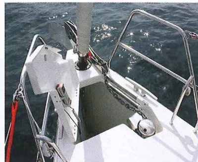
Il gavone per l'ancora a prua è capiente e il musone sporge a sufficienza per evitare eventuali urti contro il dritto di prua quasi verticale. Il tamburo dell'avvolgifiocco è recesso sotto coperta
