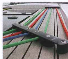
Elegante e funzionale il rinvio semi nascosto delle manovre verso i winch della tuga
