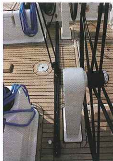
Il trasto randa è lungo 158 cm. Per lavorare la forma della randa, il vang e la base si controllano dalla tuga
